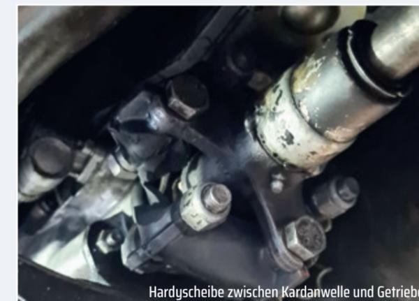
Hardyscheibe zwischen Kardanwelle und Getriebe
