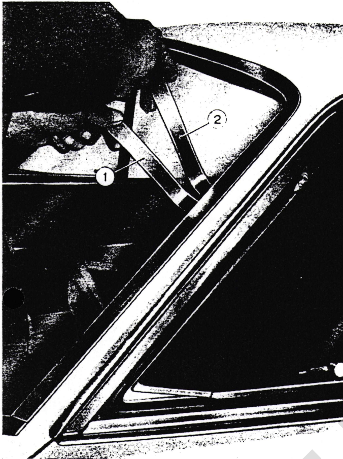
Abb. 114. - Anwendung der Werkzeuge A. 78032 zum Ausbau des Zierrahmens der Windschutzscheibe.
