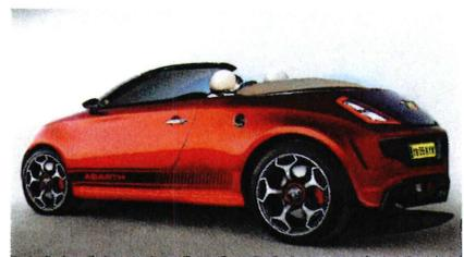
Der Zweisitzer wird mit einem 1,4-Liter-MultiAir-Motor mit variable verstellbarer Einlassnockenwelle und 180 PS aus einem Abarth 695 Tributo Ferrari angetrieben. Die Kraftübertragung übernimmt ein automatisiertes 6-Gang Schaltgetriebe. Im Sommer 2012 soll der Roadster in Deutschland zum Preis von ca. € 24.000,- an den Start gehen.
