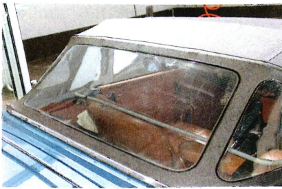
Zerkratzte, milchige Kunststoffscheiben lassen sich mit etwas Fingerspitzengefühl ebenfalls retten
