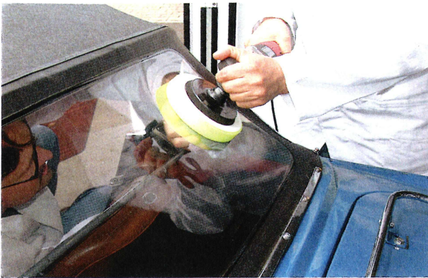
Die Polierarbeiten nie alleine durchführen! Durch zu großen Druck und zu große Hitzeentwicklung kann das Material eintrüben oder seine Spannung verlieren
