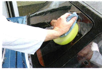
Auf einer Seite brummt die Poliermaschine, auf der anderen Seite sorgt ein Helfer für ordentlich Gegendruck
