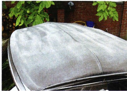
Die alte Impregnung muss mit Wasser und Spezialreiniger rückstandslos entfernt werden
