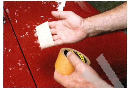
Um Fusseln und hartnäckige Verunreinigungen am getrockneten Dach aufzunehmen genügt Klebeband
