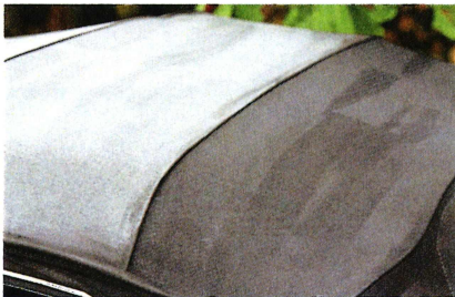
Die Spuren der Pinselstriche verschwinden beim Trocknen. Fall nicht, muss nachgearbeitet werden
