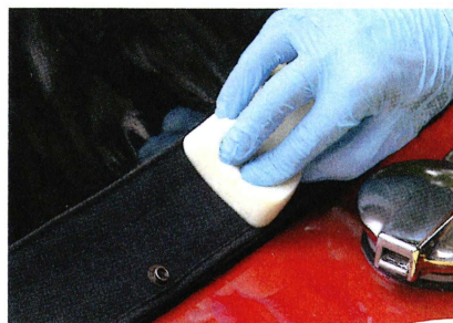
So lange pinseln, bis der Stoff keine Farbe mehr aufnimmt. Pfützen mit dem Schwamm wegwischen
