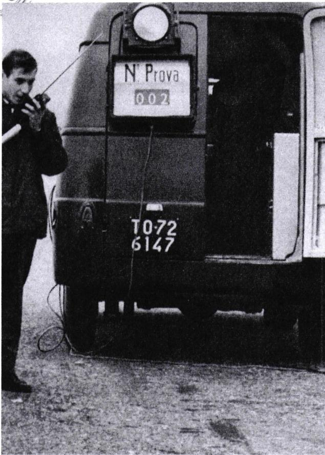
Grünes Licht für Meßfahrt Nr. 2 wird eben angezeigt. Über eine Strecke von vier Kilometern wird die Zeit für 400 m, 1000 m und die gesamte Distanz elektronisch gemessen. Beim Durchfahren der Vierkilometermarke wird außerdem die Endgeschwindigkeit aufgezeichnet.
