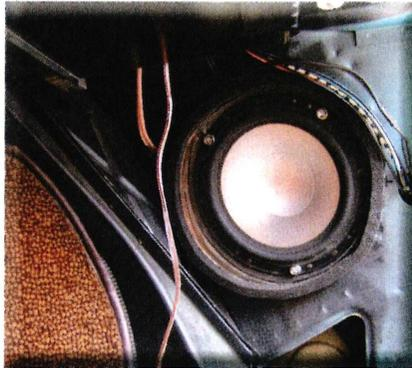
Aber jetzt stand der Einbau der Gehäuse an. Lautsprecheröffnung rein, die bestehende Öffnung im Blech auf den 16er angepasst, und? Passt! Die Kontaktfläche zur Karosserie hab ich mit Würth „Klebt und Dichtet“ Dauerhaft geschlossen. Dämmwolle und Chassis rein, fertig.
