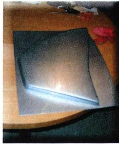
schliffen. Das sah schon sehr viel versprechend aus! Jetzt wurde die Trennlinie festgelegt und genau an dieser die schönen Teile in zwei Hälften getrennt. Anschließend auf eine Grundplatte aus Hartfaser aufgeklebt und in silbergrau-metallic-farbigem Autolack lackiert (hatte halt nichts anderes zur Hand).
