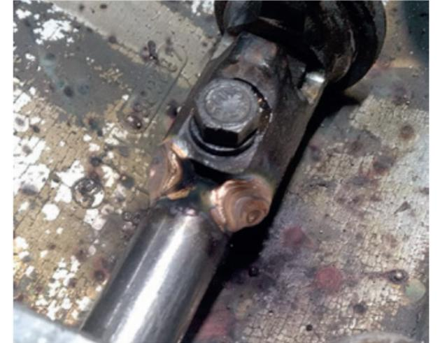
Die Ursache des Rasselns liegt im Oberdeckel der Schaltstange wo sie mit einer Mutter befestigt ist. Wird das Getriebe ausgebaut, repariert oder erneuert, z.B. bei einer Kupplungsreparatur, kann man gleich das Gestänge mit zwei Punkten verschweißen. Geschweißt wird direkt in der Schaltkulisse, wozu diese vom Getriebe abgebaut werden muss. Damit ist das Ganghebelrasseln behoben.
