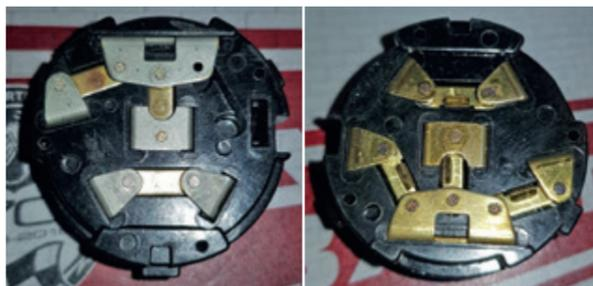
Zum Schluss noch ein Tipp: Die Lebensdauer des Zündschlösses kann man durch Einbau eines Relais verlängern. Alles natürlich „ohne Gewähr“. Und immer vorher die Batterieverbindungen lösen!
