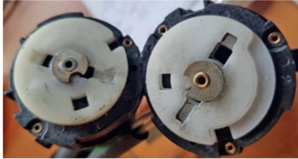
Achtung: Die unterschiedlichen „Schaltscheiben“ sollten berücksichtigt werden. Vermutlichen unterscheiden sich diese von der Vergaser- und der Einspritzer-Version. Auch gibt es bei älteren Modellen Zündschlösser mit weniger Kontakten.
