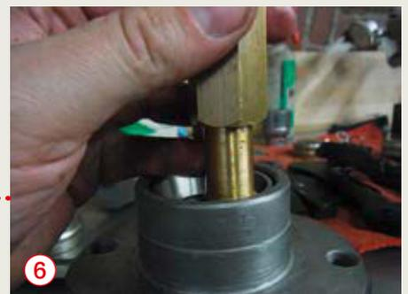
Die neuen Lagersitze können wir nun sowohl mit dem Spezialwerkzeug eintreiben, aber auch eine Passende Nuss oder ein selbstgebautes Druckstück und ein stabiler Schraubstock funktionieren gut. Auch die Montage des Lagersitzes mit einem Dorn aus Weichmetall ist möglich, verlangt aber nach Fingerspitzengefühl. Vor der Montage die Radnabe innen natürlich gründlich säubern (Bild 3, Bild 4, Bild 5, Bild 6).
