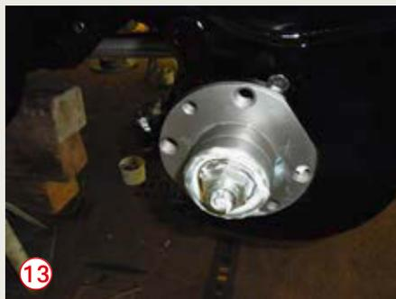
Das setzen der Lager sowie die genaue Einstellung werden wir später vornehmen (Bild 10, Bild 12, Bild 13). Der nächste Schritt ist das anbringen der Brems Scheibe an der Radnabe (Bild 14) und die Montage des Bremszangenhalters (Bild 15). Nun folgt der Einbau der Bremsbeläge (Bild 16). Sind die Federn die
