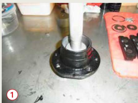
Dieses Werkzeug habe ich mal angefertigt und es funktioniert gut. Mit diesem Werkzeug kann man die Lagerschalen sowohl ein- und ausbauen. Es werden aber auch im Internet, relativ günstig, Universalsets angeboten mit denen man Radlager ein- und austreiben kann.
