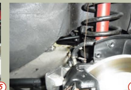
Um Beschädigungen am Bremschlauch zu vermeiden, hängen wir die Bremszange mithilfe eines Schweißdrahtes oder etwas Ähnlichem an der Karosserie auf.
