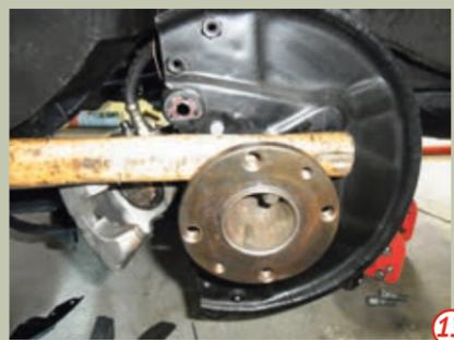
Oft lässt sich die Steckachse per Hand einfach herausziehen oder man hebelt sie mit einem Hammerstiel heraus. **13**
