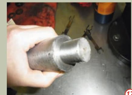
gummiert. Den Simmering baue ich mit einem selbstgebauten Werkzeug ein, weil er etwas zurückversetzt ist. **17**
