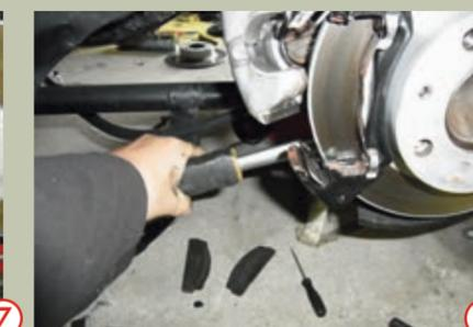
Nun können wir nach dem Entfernen der Bremsbeläge die zwei Befestigungsschrauben entfernen.
