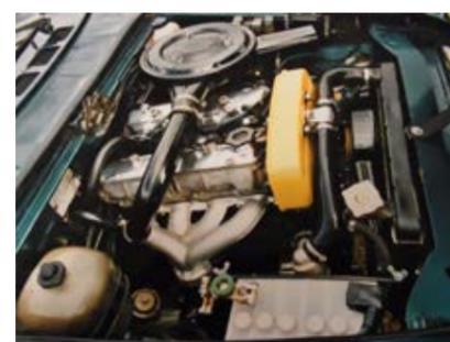
der Nockenwellenkasten der Auslasses getauscht sowie der Zündverteiler vom Motorblock auf den Nockenwellenkasten wandern. Alle Teile, die zum Umbau benötigt wurden, beschaffte ich und überholte sie dann, soweit das nötig war. Da ich die Betätigung der Vergaseranlage mit einem Gaszug bevorzuge, fertigte ich eine Umlenkung an, die das ermöglichte.
