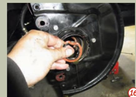
Im Gehäuse ist noch ein O-Ring eingelegt, der zum Außenring des Radlagers abdichtet. Diesen entfernen wir aus der Nut. Aber Achtung! Der Ring wird von vielen Händlern falsch geliefert. Er muss 65 x 2 mm messen, wird aber oft in 65 x 1,5 mm geliefert. Dann braucht man ihn auch nicht zu montieren!
