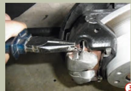
Im nächsten Schritt entfernen wir die vier Splinte der Gleitsteine, die die Bremszange halten und entfernen die Gleitsteine mit Hilfe eines Schraubendrehers.
