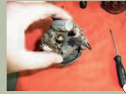
Sobald diese Operation durchgeführt wurde, kann es, nach Entfernen der beiden Schrauben, mit der Demontage der Kontaktplatte weitergehen **7** und die Verteilerwelle aus dem Gehäuse gezogen werden. **8**
