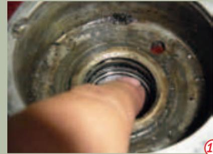
Nun entfernen wir noch die O-Ringe hinter den Lagern aus dem Verteilergehäuse **15** und die O-Ringe aus der Verteilerwelle. **16**
