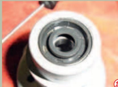
Den Überholsatz bekommt man für etwa zehn Euro. (z.B. bei O.u.S.) Leider sind in diesem Satz nur die Lager und der Simmering, nicht aber die O-Ringe enthalten. Das sind aber Normteile, die im Fachhandel gekauft werden können. Oder ihr besorgt euch gleich ein O-Ring-Sortiment, in dem die benötigten Größen enthalten sind. Die O-Ringe haben die Größen  $\varnothing 28\text{mm}/2\text{mm}$  Stärke und  $\varnothing 9\text{mm}/1,5\text{mm}$ .
