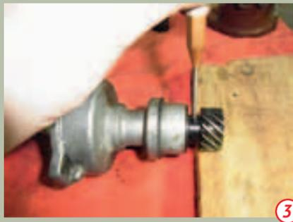
Diesen entfernen wir mit einem passenden Durchschlag. **3** Dazu ist es eventuell hilfreich, eine zweite Person hinzuzuziehen, die den Verteiler festhält. Leider gelingt es aber nicht immer, den Stift zu entfernen, oder der benötigte Kraftaufwand wird zu groß. Dann muss, um das Material zu schonen, zur
