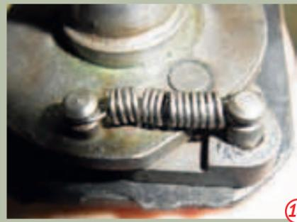
Nun können wir den Zündverteiler mithilfe eines Überholsatzes in umgekehrter Reihenfolge des Ausbaus wieder montieren. Beim Zusammenbau unbedingt den Simmering richtig herum einbauen! **19**
