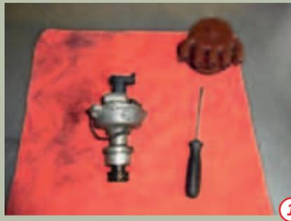
Als Erstes entfernen wir die Verteilerkappe und den Läufer. **1** Dies ist noch keine Schwierigkeit, aber der nächste Schritt ist der Kniffligste der gesamten Zerlegung: Die Entfernung des Stiftes, der das Antriebszahnrad auf der Verteilerwelle fixiert. **2**
