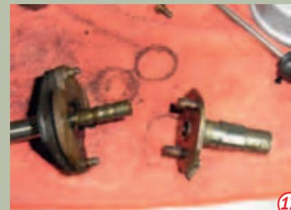
Der letzte Schritt ist die Zerlegung der Fliehkraftverstellung. Hierzu ist es nötig, die Federn auszuhängen. Bei dieser Arbeit unbedingt darauf achten, dass die Federn nicht verformt werden, denn sonst funktioniert die Fliehkraftverstellung später nicht mehr korrekt. Auch dürfen die Federn auf keinen Fall in
