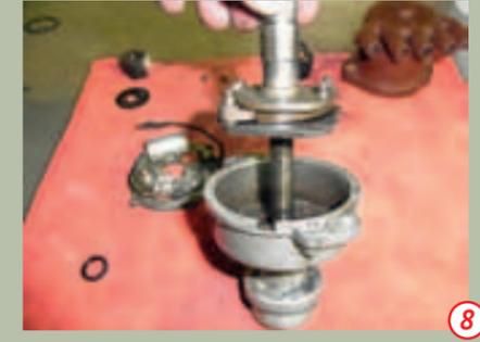
Beim Betrachten des Verteilergehäuses wird sich zeigen, dass der unten im Verteiler angebrachte Simmering entweder knochenhart und oder nur noch in Fragmenten vorhanden ist. **9**
