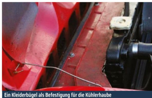
Ein Kleiderbügel als Befestigung für die Kühlerhaube
